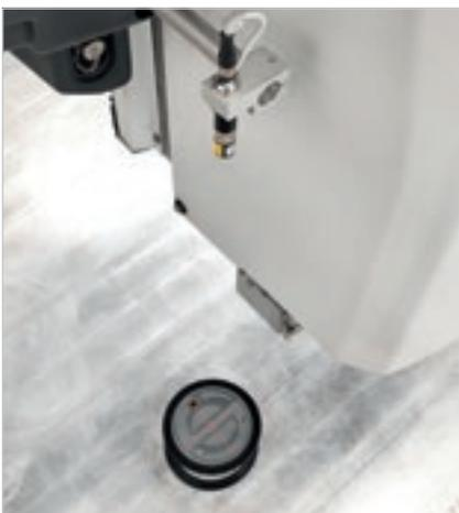
O laser em cruz guia o operador no posicionamento de ventosas e batentes acelerando as operações de apetrechamento da bancada.
