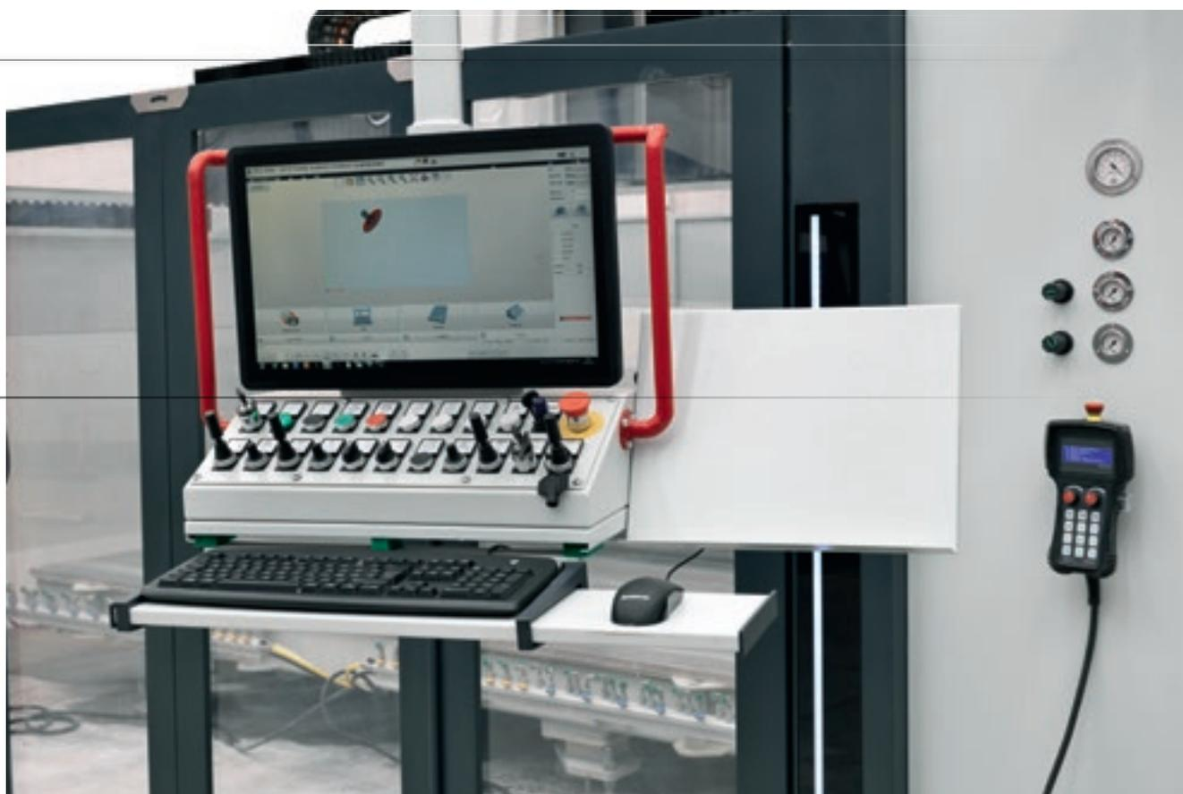
O uso de um PC com sistema operacional Windows garante uma abordagem extremamente fácil e intuitiva no uso, por parte do operador, e a total conectividade com os sistemas de rede e com os suportes óticos/magnéticos encontrados no mercado.
